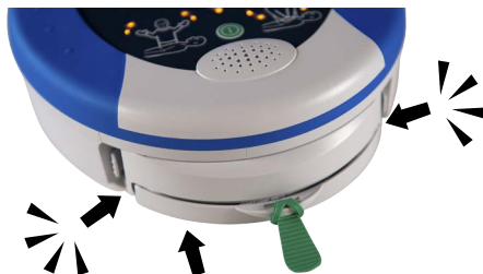
Figur 4. Isättning av Pad-Pak
